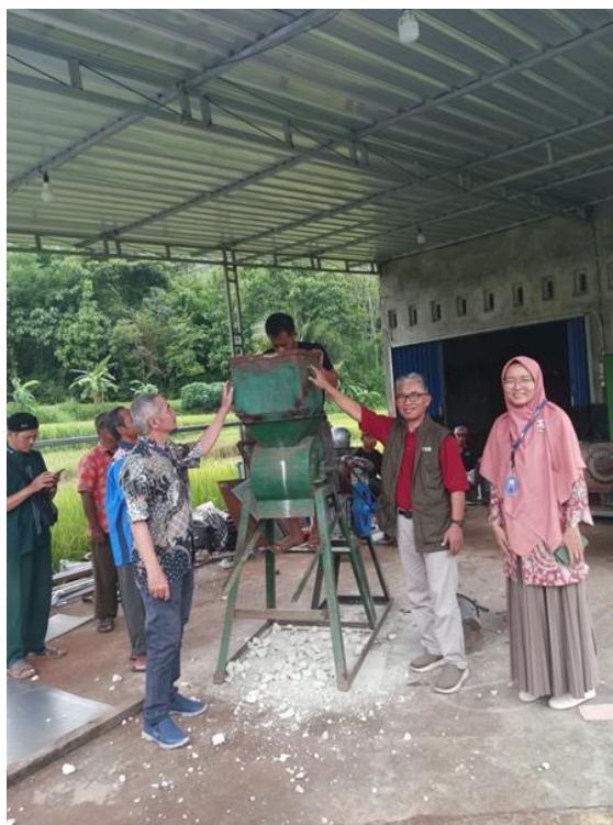
Gambar 5. Uji coba mesin pencacah batuan zeolit alam di Hargomulyo
