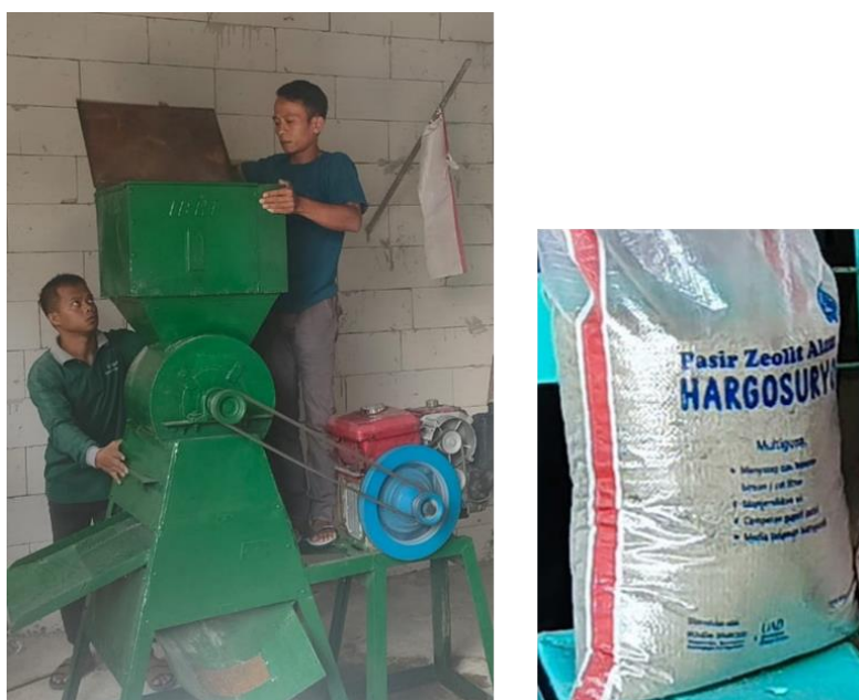
Gambar 6. Praktik operasional mesin crusher untuk produksi pasir zeolit alam
