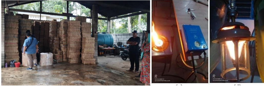
Gambar 3 hasil nyala kompor dan lampu dari biogas pemindangan
